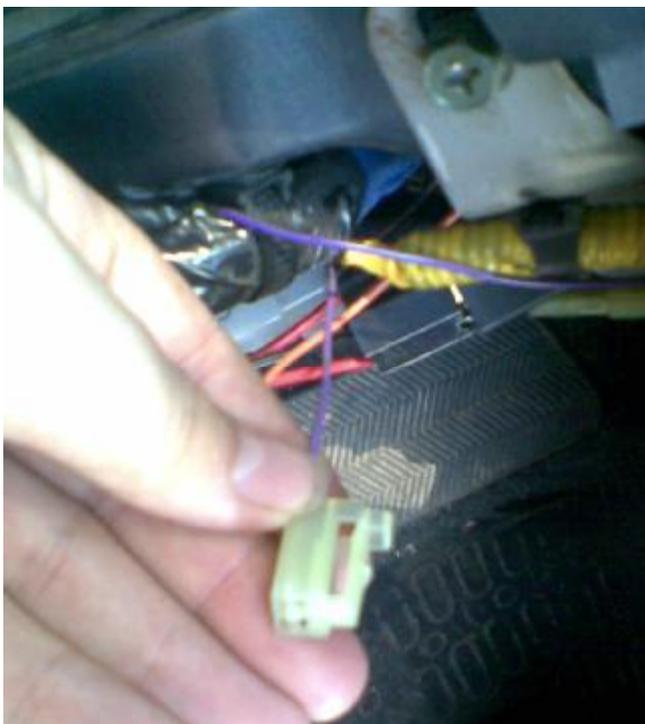
Для диагностики, нужно замкнуть это контакт на массу автомобиля и повернуть ключ зажигания в положение II (on) , но не заводить (все действия производятся на не заведенной машине!).
